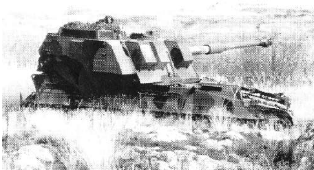
AS 90 Braveheart. En engelsk konstruktion. Väger 46 ton, skjuter lika långt som sin tyska motsvarighet och har samma kaliber, 155 mm. Vagnen har NBC-skydd och en besättning på fem personer
